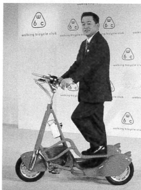
図1●片山工業の立ち漕ぎ式電動アシスト三輪自転車 歩くときに近い直立姿勢で乗ることができる。
