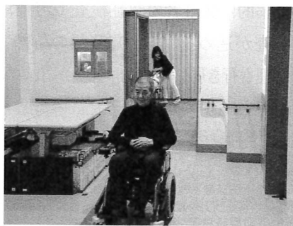
図2●ATRなどが開発した車椅子型ロボット 介護者（写真奥）の手を借りずに、被介護者（写真手前）が半自律的に移動できる。
